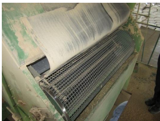
شکل ۴- دستگاه پیش بوجار مورد استفاده در خط فرآوری بذر گندم با غربال دوار (آروین صنعت، ۱۳۹۰)
