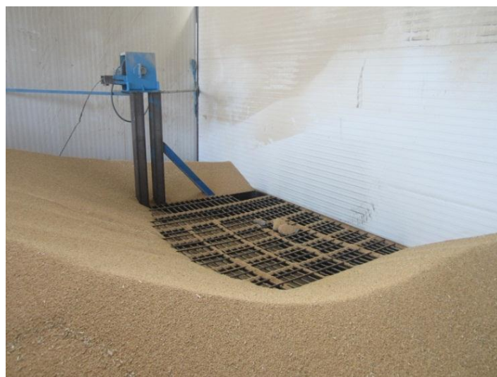
شکل ۳- تجمع بذر گندم قبل از چاله ورودی بالابر دستگاه پیش بوجار (گازر و همکاران، ۱۳۹۹)
