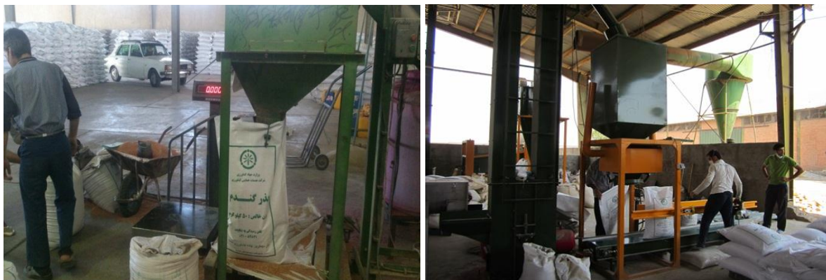
شکل ۹- دستگاه های کیسه گیری و توزین بذر اتوماتیک و دستی در خط فرآوری بذر گندم ( رام صنعت بهاره، ۱۳۹۰ آروین صنعت، ۱۳۹۰)
