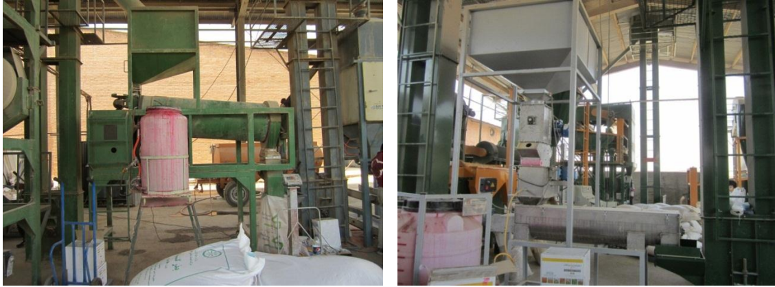
شکل ۸- دستگاه‌های سمزن در خط فرآوری بذر گندم (رام صنعت بهاره، ۱۳۹۰، آروین صتعت، ۱۳۹۰)
